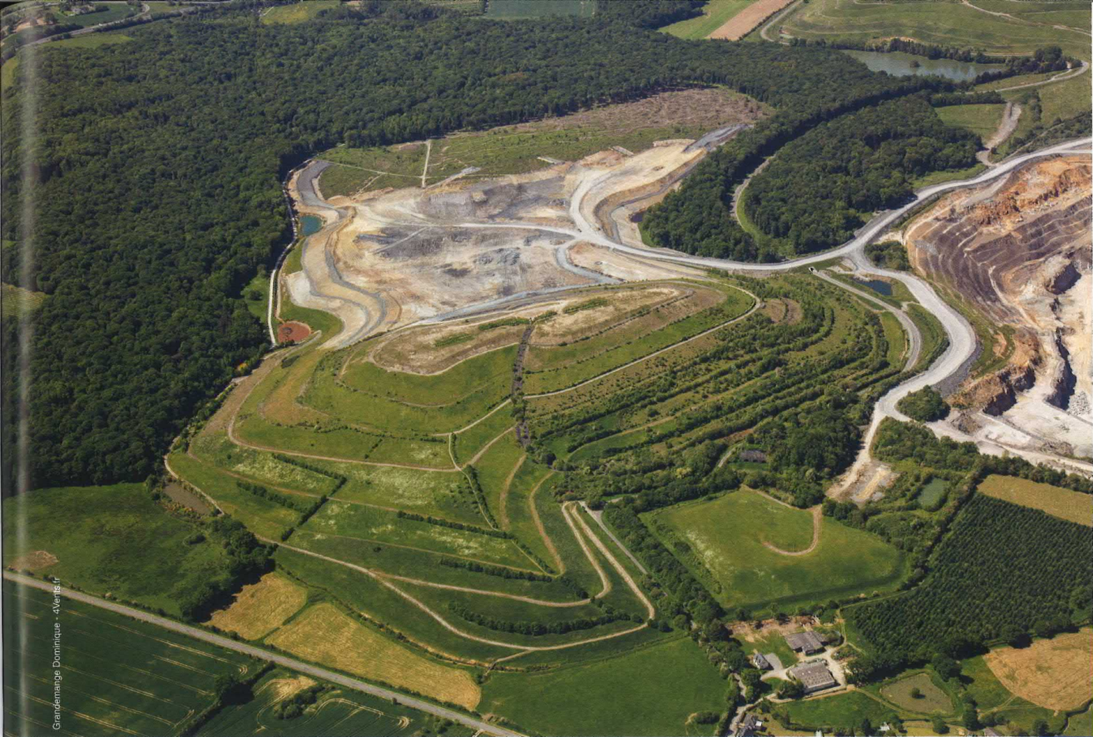
Figure 3 – Exemple de réaménagement d'une verse d'argile à l'avancement avec pistes de gestion des eaux en courbes de niveau permettant de séparer les talus en plusieurs sections, bassins et descentes d'eau (Maîtrise d'œuvre Mica Environnement).
